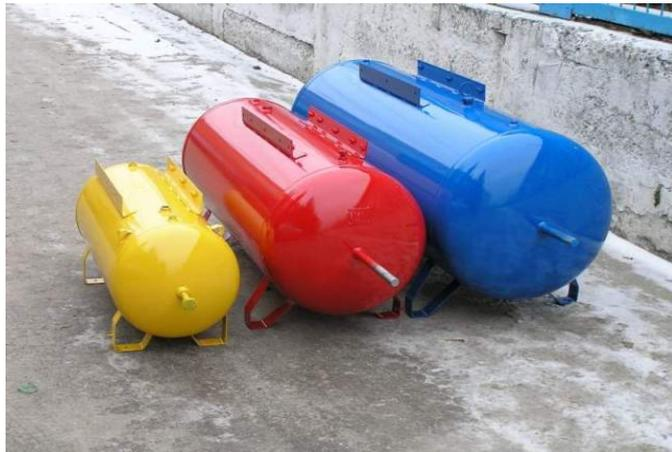
**Сосуды, работающие под давлением** представляют собой герметичные закрытые ёмкости, которые используются для хранения и транспортировки различных газов, нефтепродуктов и жидкостей под давлением. Резервуары такого типа должны соответствовать всем правилам и нормам, поэтому их изготовлением сопряжено с обязательным следованием тех.заданию заказчика, проектной документации и специальным "правилам устройства и безопасной эксплуатации сосудов, работающих под давлением".
